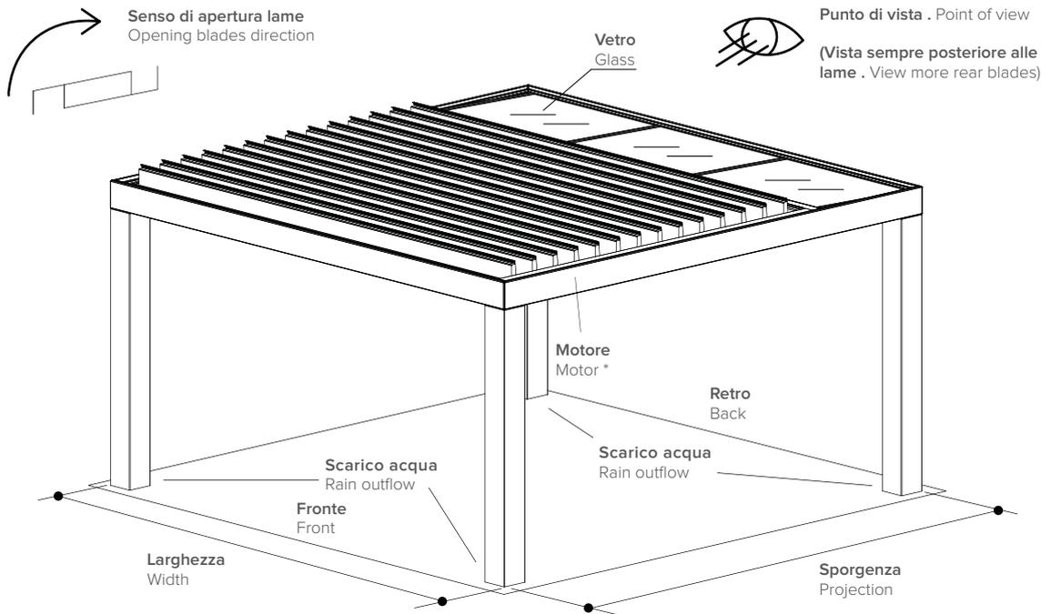
\* Esempio di motore posizionato lato sinistro rispetto il punto di vista . Example of motor situated left side respect the point of view.
