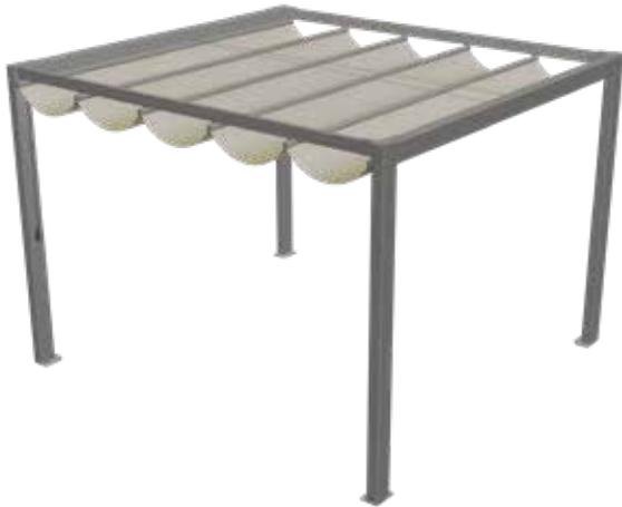
Tenda autoportante con piantane 13x8 cm. e guide sopra il telo, profili orizzontali scorrevoli che permettono alla tenda il caratteristico aspetto "a onde" (ogni 50 cm circa). Funzionante a fune e rinvii con carrucole.
